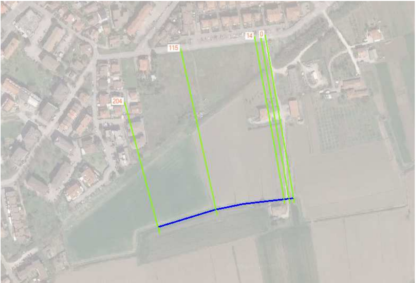
Figura 7: Planimetria con indicazione delle sezioni rilevate e utilizzate per la modellazione idraulica
